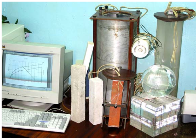
Рис. 10.13. Термографическое исследование на ЭВМ теплофизических свойств строительных материалов
