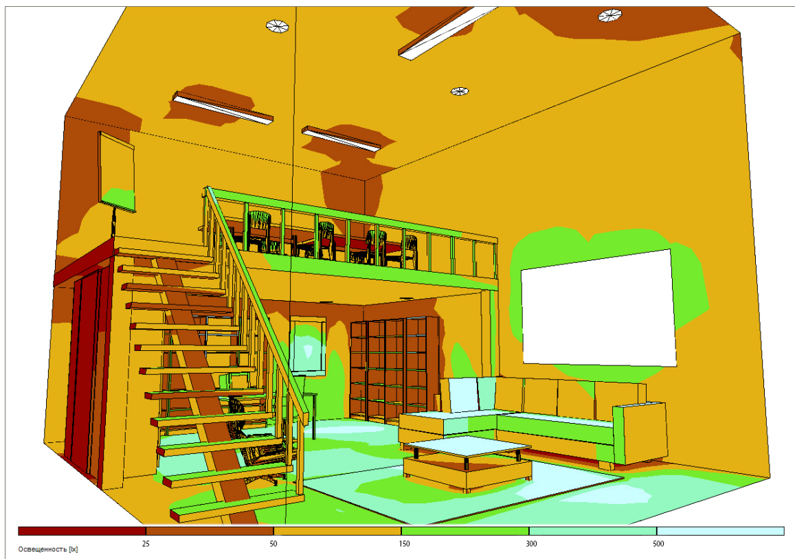
Рис. 3.13. Распределение освещенности в помещении при моделировании совмещенного освещения (включены все световые приборы)
